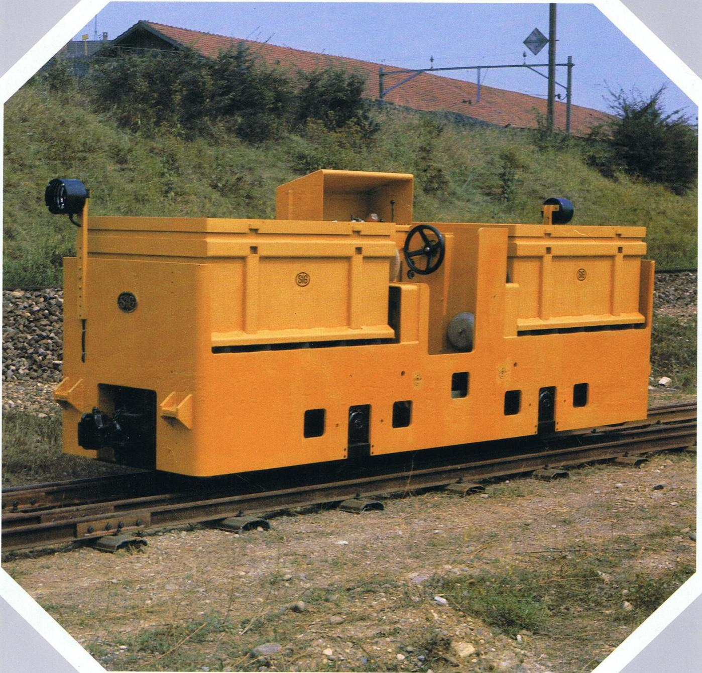
Locotracteurs bi-moteur pour écartements étroits, avec commande par combinateur de tambours à cames, pour travaux en construction de tunnels et galeries.
